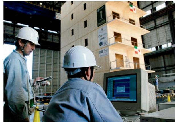
Fasi del montaggio della strumentazione all'interno della palazzina di sette piani, prove seguite attraverso i monitor, sede della piattaforma per le simulazioni sismiche
